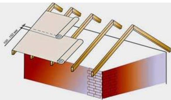
Рис.1. Укладка гидроизоляционной плёнки
