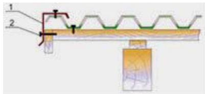
Рис.9. Поперечное примыкание ската к стене.
