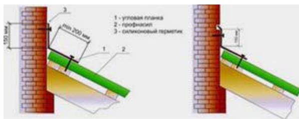
Рис.8. Продольное примыкание ската к стене.
