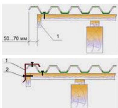
Рис.6. Поперечный разрез фронтон: 1 - ветровая рейка 25 x 80 мм
