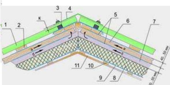
Рис.2. Утеплённая кровля: 1 - профнастил (металлическая черепица); 2 - обрешётка; 3 - уплотнитель коньковый; 4 - конёк; 5 - гидроизоляционная пленка; 6 - стропильная планка (брус контробрешетки); 7 - стропильная нога; 8 - утеплитель; 9 - пароизоляционная плёнка; 10 - потолочная рейка; 11 - гипсокартон, вагонка; а - продкровельная вентиляция; б - вентиляция между утеплителем и гидроизоляционной пленкой
