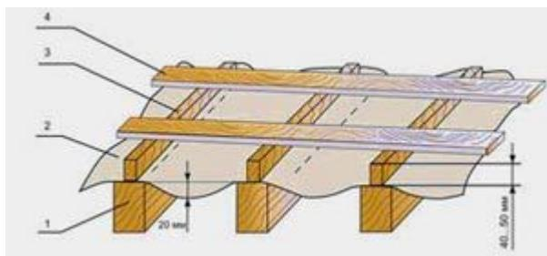
Рис.3. Укладка гидроизоляционной пленки и обрешётки: 1 - стропильная нога; 2 - гидроизоляция; 3 - стропильная планка (брус конробрешетки); 4 - обрешётка
