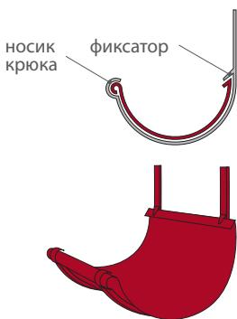
Вставьте желоб в крюк, заведя внутренний край желоба в фиксатор, затем зафиксируйте внешний край желоба накидным пластинчатым фиксатором (рис. 4). Внешний край желоба должен быть ниже внутреннего на 6 мм в целях предотвращения попадания воды на фасад во время сильных ливней.
