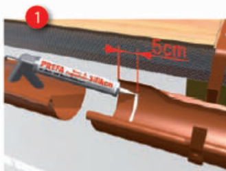
Нанесите несколько полос клея Prefa толщиной около 8 мм.
