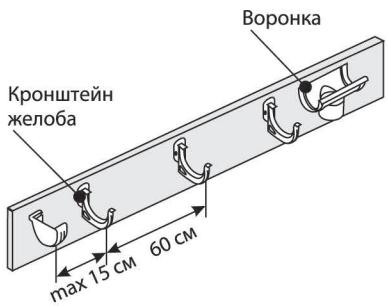
**6.** После монтажа кронштейнов желоба прикрепите воронки и соединительные муфты на лобовую доску либо на металлические кронштейны (в зависимости от выбранного варианта крепления желоба).
