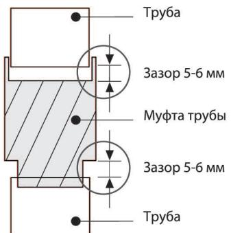
**ВАЖНО:** все отрезки труб должны вставляться в колена трубы, муфты трубы, тройники и нижнее (сливное) колено с необходимым зазором в 5-6 мм для компенсации теплового расширения.
