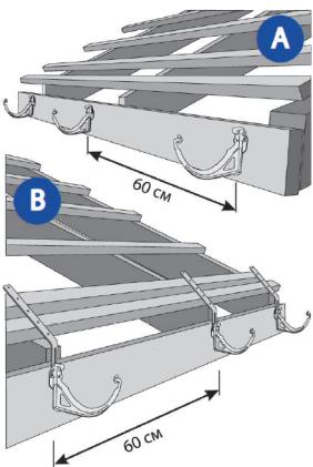
**ВАЖНО:** металлические кронштейны (удлинители) монтируются до монтажа кровельного материала.
