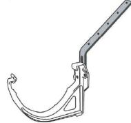
5. При монтаже водосточной системы на лобовую (карнизовую) доску также с помощью шнура задайте уклон в 3 см на каждые 10 м в сторону воронки и закрепите пластиковые кронштейны желоба непосредственно на лобовую доску с шагом 50-60 см.
