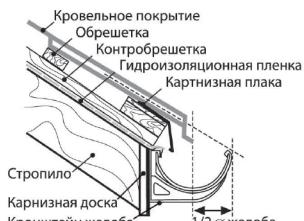
3. Отметьте на самом удаленном от места установки воронки металлическом кронштейне (в вертикальной части, где паз), горизонтальную черту. Затем натяните шнур до ближайшего к воронке кронштейна, задайте уклон 3 см на каждые 10 метров. По шнуру сделайте на металлических кронштейнах отметки, обозначающие места крепления пластиковых кронштейнов желоба.
