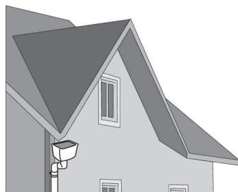
**12.** Для перехода от воронки к водосточной трубе используйте два колена трубы и вставку из отрезка трубы. При соединении трубы с коленом или муфтой трубы необходимо оставить зазор в 5-6 мм для компенсации теплового расширения.
