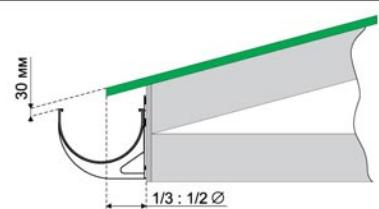
Свес крыши располагается над желобом на расстоянии от 1/3 до 1/2 его диаметра.
